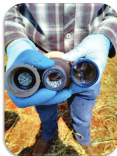
Figura 1. Sensor de pressão entupido o que compromete o sistema eletrônico e a vazão na linha principal (A); incompatibilidade da mistura de herbicidas e o consequente entupimento nos filtros de barra (B).
