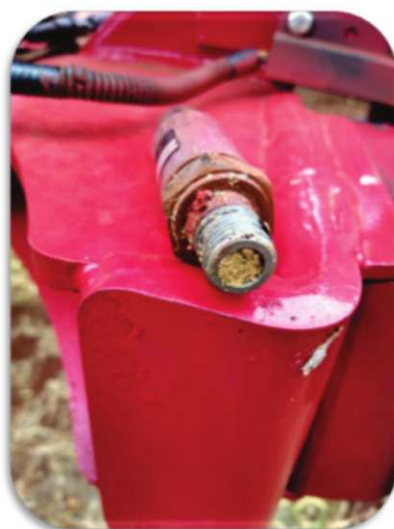
Figura 1. Sensor de pressão entupido o que compromete o sistema eletrônico e a vazão na linha principal (A); incompatibilidade da mistura de herbicidas e o consequente entupimento nos filtros de barra (B).
